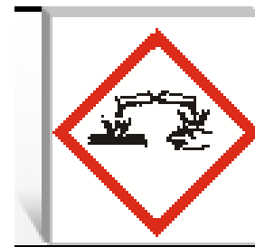
金屬性腐蝕物 皮膚腐蝕
